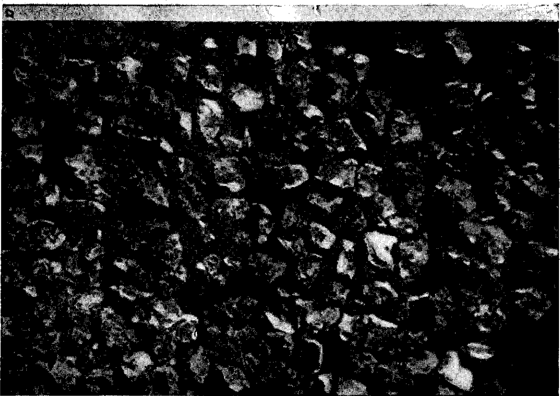
Рис. 5.2. Микрофотография зерен ионита, полученных размагнитанием более крупных частиц (а) и дисперсионной полимеризацией (б). Зерна типа б более пригодны для хроматографии. Они в меньшей степени подвержены флосию и прочнее. Слой этих частиц обладает меньшим гидродинамическим сопротивлением. Также частицы выдерживают большее рабочее давление и высокие скорости потока подвижной фазы.
